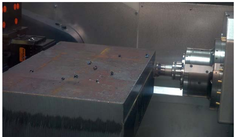
So geht es los: Das Bauteil im Ausgangszustand ist 250 kg schwer, es wird 500 mm vom Tisch entfernt gefräst – und dabei sicher vom EvoGrip gehalten.
