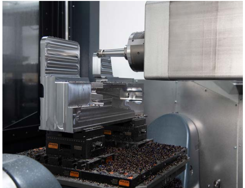
Zusammen mit dem Nullpunktspannsystem EvoPoint bietet der Zentrischspanner dank optimaler Schnittstelle eine Spannkraft von bis zu 7,5 t sowie eine hohe Flexibilität bei den Spannmöglichkeiten.
