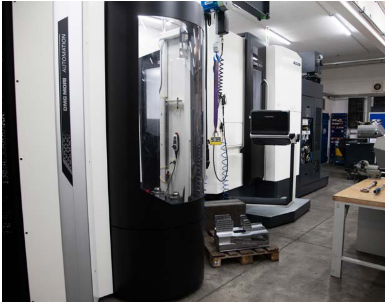
Das horizontale 5-Achs-BAZ DMU 85 H monoblock mit dem Rundspeicher PH Cell 800 für das Palettenhandling ist heute Kernelement der Fräsabteilung von Andreas Schweiger.
